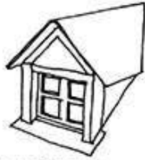
Lucarne à 2 pans, dites jacobine , en bâtière
